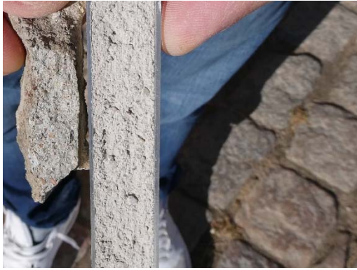
Jämförelse av gammalt fogbruk (vänster) och prov på nytt bruk (höger).
