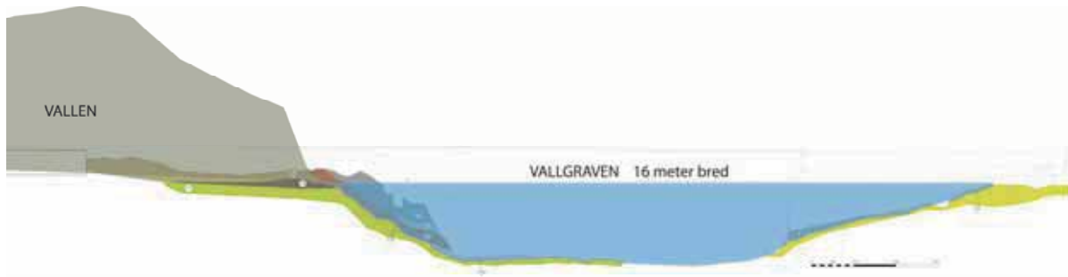
Figur 34. Tvärsnitt av vallgraven. Den västra sektionen i Schakt 3 med äldre marklager till vänster, skurna av nedgrävningen för vallgraven. Inledningsvis var vallgravens bredd i området omkring 16 m. Vattennivån bör ha varierat under året. Vallens höjd är på bilden estimerad.
