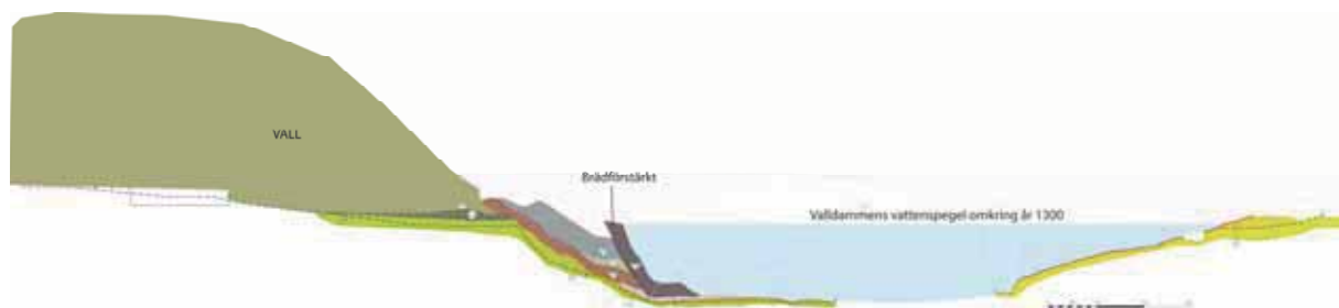
Figur 42. Den västra sektionen i schakt 3, med tvärsnitt genom vallgraven. En nedgrävningskant i form av ett "L" visar omvandlingen från vallgrav till damm. Troligen utgjordes "L:et" av nedbrutet trä som stagat upp den södra kanten av dammen. Formen syntes även i den östra schaktväggen. Vallens höjd och bredd är estimerad, då endast vallfoten fanns kvar vid undersökningen.
