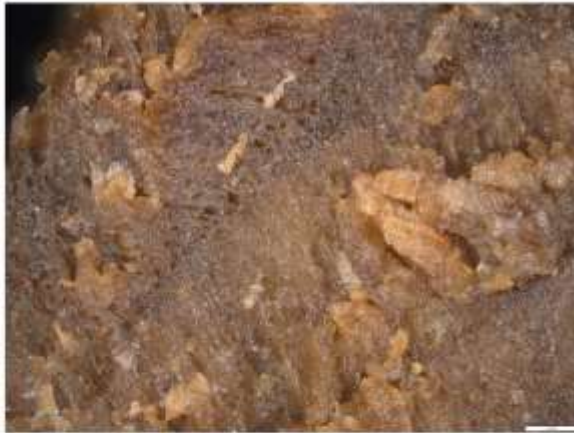
Tvårsnitt av plugg gjort av hassel.
