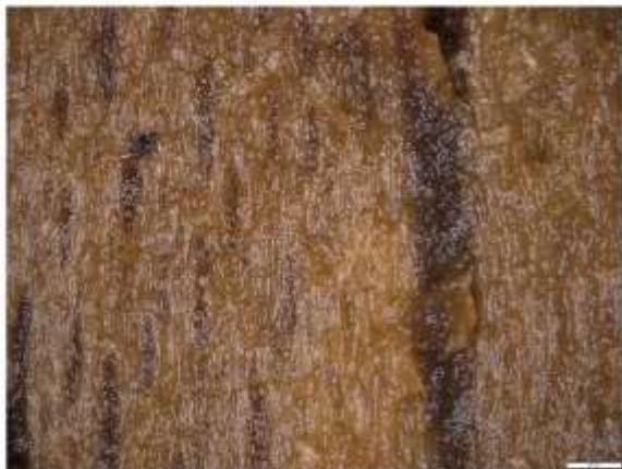
Tangentialsnitt av laggstav 1 gjort av bok.
