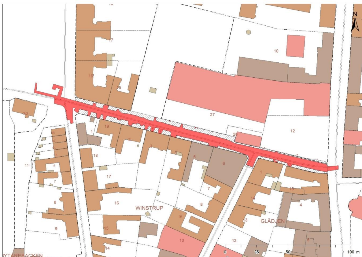
Figur 7. Schaktad yta i och med markarbeten i Sankt Petri Kyrkogata. Rött område motsvarar schaktdjup på 1–3 m och streckat område motsvarar schaktdjup på ca 0,20–0,50 m. Fastighetskartan © Lantmäteriet.
