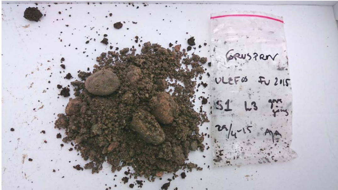
Figur 10. Grusprov från Schakt 1. Grusprovet är representativt för samtliga gånger där rundade småsten i olika storlekar är påträffade.
