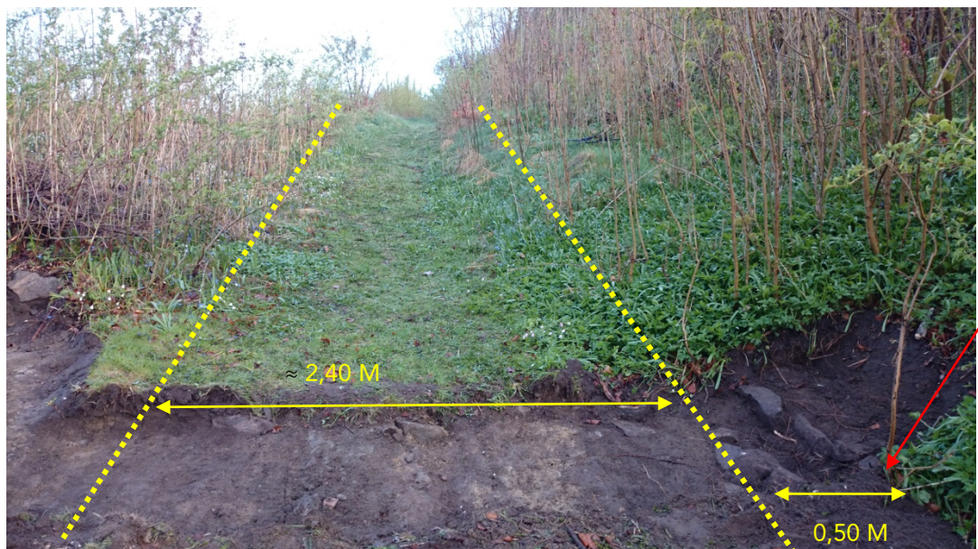
Figur 40. Schakt 14. Öster om gången i nordsydlig orientering fanns en rännal (röd pil) uppbyggd av sten med en skifferplatta i botten. Kompakt lera centralt i gången fungerade som vattenavledare.
