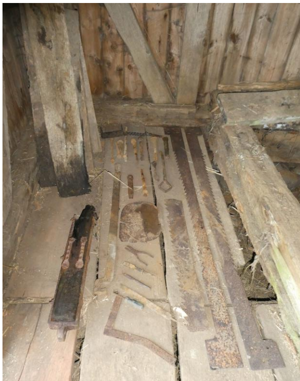
Äldre verktyg som påträffades under arbetet, bland annat verktyg för timmerarbeten men också sågblad som kan ha använts i sågmöllan.
