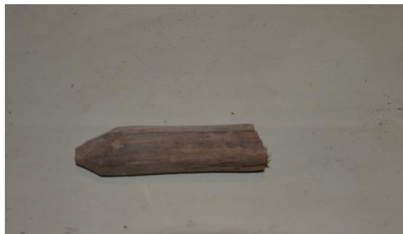
Figur 14. Valv 1, tornet. Dubb som haft som funktion att hålla samman delar i takstolen. De kan vara medeltida eftersom den medeltida takstolen är bevarad.
