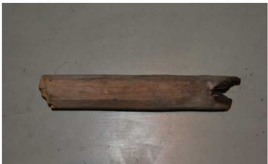
Figur 14. Valv 1, tornet. Dubb som haft som funktion att hålla samman delar i takstolen. De kan vara medeltida eftersom den medeltida takstolen är bevarad.
