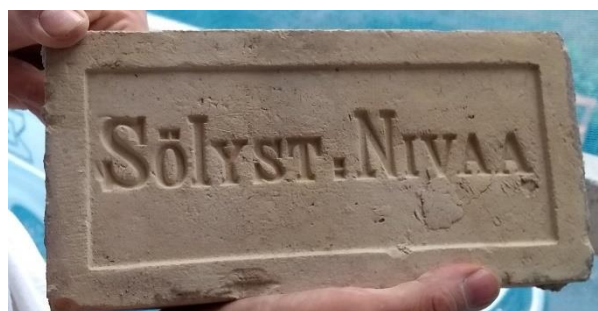
Figur 14. I sprickan i trappgaveln finns gult tegel stämplat F.H Fredrichsen på en sida och Sölyst Nivva på andra sidan. Ett antal stenar murades om.
