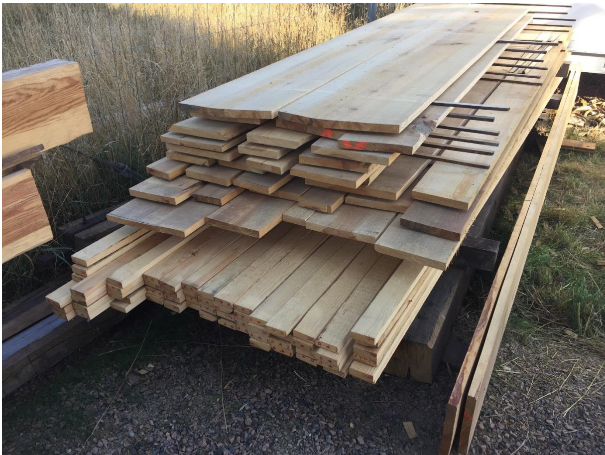
Foto visar panel av sidobräderna som sågats från vingbalkarna.
