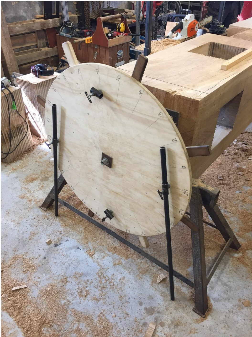
Det 24-gradiga "spelet" som axeln roteras kring vid svarvningen av axeln.
