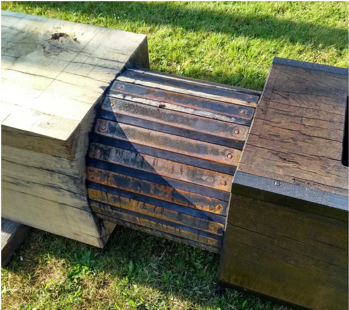
Löpjärnen monterade på den nya axeln och med mellanlägg av bok.
