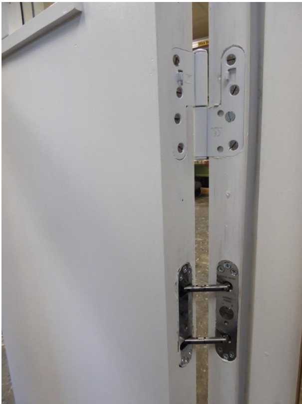
Tillverkning av nya dörrar. Specialtillverkad ytterpanel och löstagbar spröjs samt dörrstängarens position.
