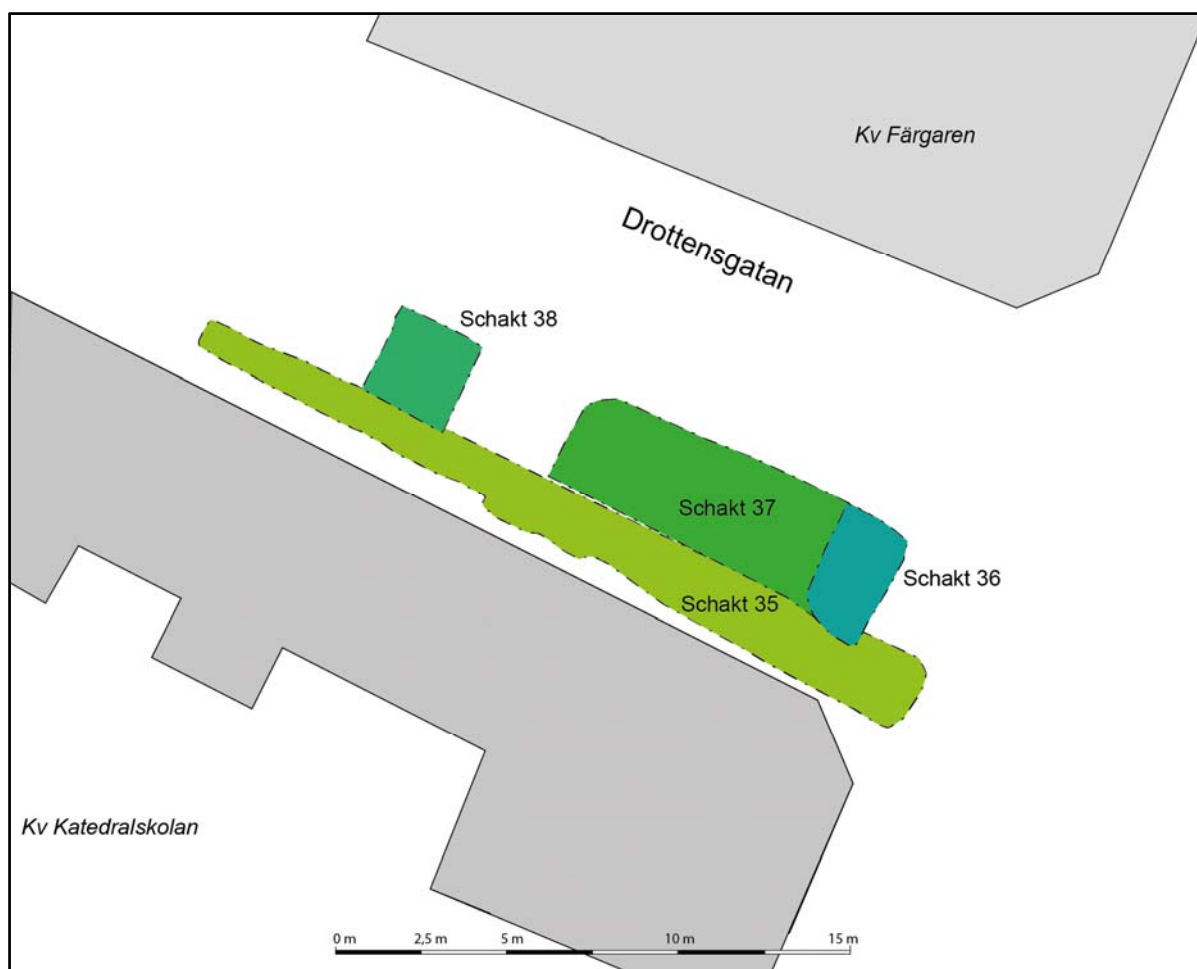
Figur 44. Läge för, och benämning av, de schakt som togs upp i Drottensgatans östligaste del i samband med kabelsänkning, flytt av rensbrunn och trädplantering. (jfr fig. 6).
