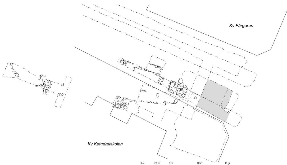
Figur 26. De delar av grunderna till S:t Andreas kyrka som påträffats vid undersökningar 1981, 1986 och 2018. Den grå ytan visar den bevarade utbredningen av den stenläggning som framkom 2018.
