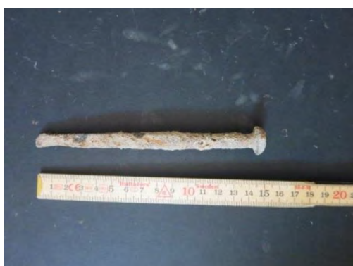
Figur 19. Bilder över spik som påträffades. 1. Trådspik och en skruv. 2. Trådspik möjligen för att fästa taktäckningsmaterial. 3. Större spik som kan ha använts som förstärkning i taklaget. 4. En avklippt handsmidd spik.
