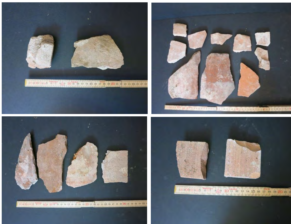
Figur 18. Fragment av enkopigt vingtegel och längst ner till höger fragment av modernt taktegel.
