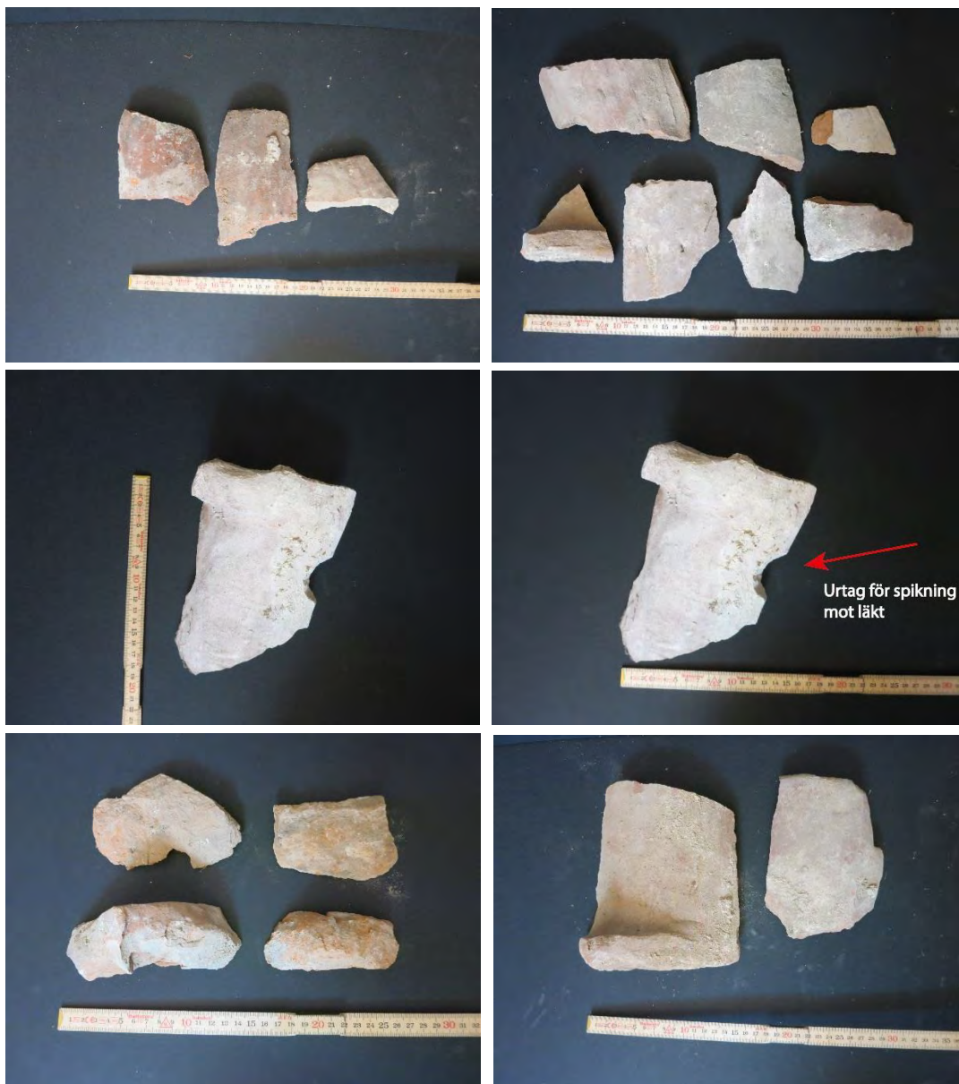
Figur 14. Bilder över fragment av medeltida nunnetegel. På ett av takteglen fanns ett urtag i sidan där man kunnat fästa teglet med spik mot läkten.
