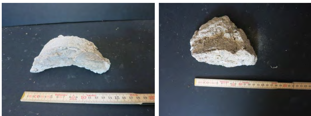
Figur 15. Bilder av bruk som använts för att fästa nunnetegel mot murkrönets trappavsatser.
