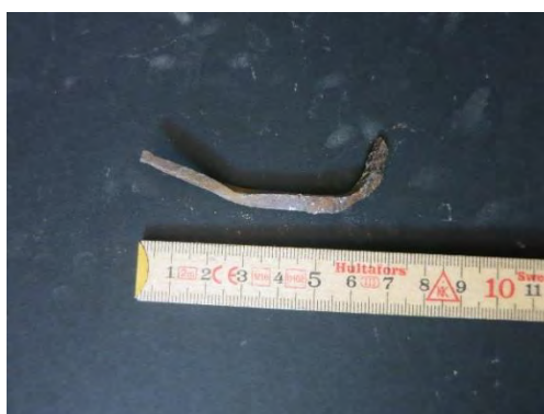
Figur 19. Bilder över spik som påträffades. 1. Trådspik och en skruv. 2. Trådspik möjligen för att fästa taktäckningsmaterial. 3. Större spik som kan ha använts som förstärkning i taklaget. 4. En avklippt handsmidd spik.
