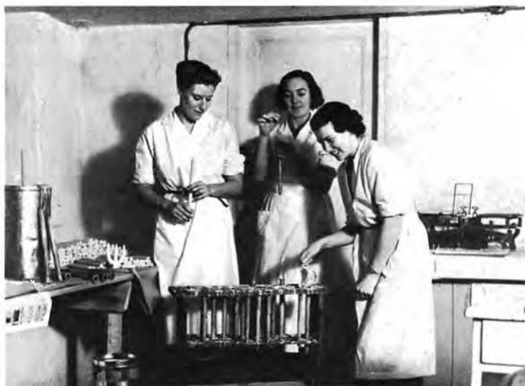
7. Stöpning av formljus på Kulturen 1938. Ljusen stöps i tennformar uppsatta i en träställning. KM 25.163.
