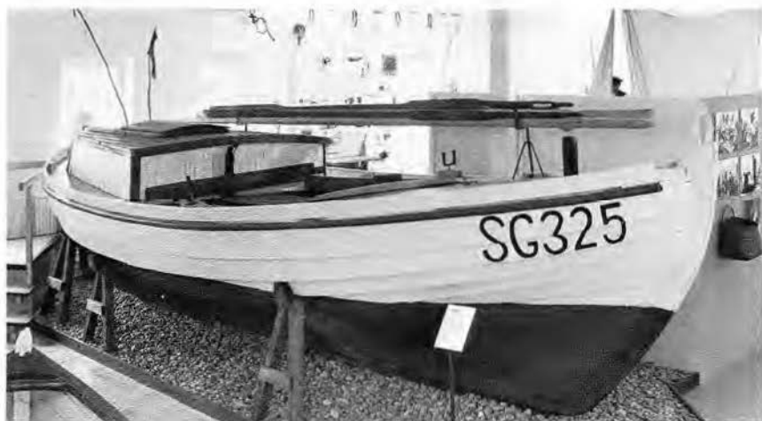
1. Däcksbåt eller vrakbåt från Västra Näs, byggd i Pukavik 1926; längd 22 fot (ca 6,5 m), utrustad med sprisegelsrigg och 4 hkr Västerviksmotor. Förvärvat till Kulturen 1972. KM 64.264.
