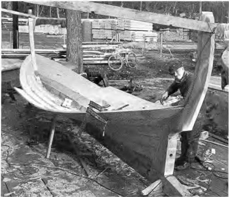
6. En knubb under byggnad 1969 hos båtbyggaren Gustaf Palmquist i Ronnebyhamn. Foto förf.
