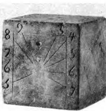
Bild 7—10. Kombinerat horisontal- och vertikalarur med syd-, öst-, väst- och nordur, kalksten. Horisontalaruret (Bild 7) visar tiden 3 f. m.—11 e. m., syduret (Bild 8) 6 f. m.—6 e. m., östuret (Bild ej medtagen) 3 f. m.—11 f. m., västuret (Bild 9) 1 e. m.—9 e. m., norduret (Bild 10) 3 f. m.—7 f. m. och 5 e. m.—9 e. m. KM: 6.711.
