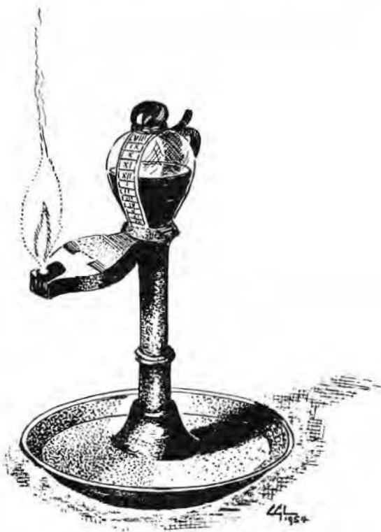
Bild 49. Kombinerad lam- pa och klocka. Detta olje- ur från 1700-talet har på oljebehållarens sida ett graderat timband. När lam- pan brinner, sjunker olje- nivån ett streck i timmen. Timsiffrorna anger tiden från 8 f. m.—7 e. m. Skiss efter oljeur i The Science Museum, London.
