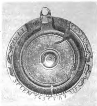
Bild 38—39. Portativt solur med sidoställd skuggkastare och vridbar urtavla, fram- och baksida. På bakstycket sitter mitt emot upphängningsbygeln en visarspets, vilken pekar på en gradering på den rörliga urtavlans baksida. Graderingen anger solens uppgångstider under året. Avläsaren måste således känna till tidpunkten för solens uppgång avläsningsdagen för att kunna få rätt tid. KM: 22.681.
