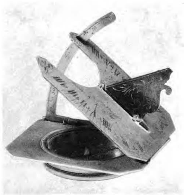
Bild 33. Hopfällbart kompassur av mässing, använt som reseur. Urtavlan kan inställas efter en graderad skala, svarande mot breddgraden för uppehållsplatsen. Uret är tillverkat i Paris av Baradette. Sannolikt 1700-tal. KM: Om.
