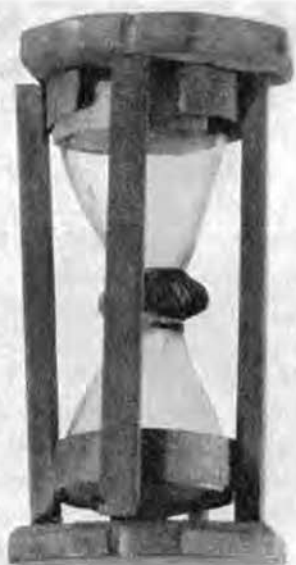
Bild 45. Logglas från Skanör, be- stående av två flaskor sammanfäs- tade med en perforerad metall- skiva emellan. KM: 6.633.
