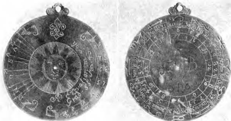
Bild 36—37. Portativt solur med skuggkastare i centrum, fram- och baksida. Till vänster synes månadernas initialer, till höger timsiffrorna. Uret är avsett att hänga i bygeln, så att skuggan faller utesfter urtavlan mot siffrorna. Uret kan utan beräkningar endast visa soltid. KM: 8.7118.
