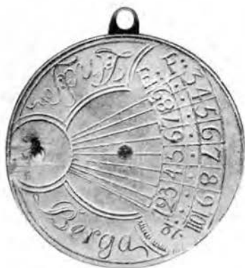
Bild 38—39. Portativt solur med sidoställd skuggkastare och vridbar urtavla, fram- och baksida. På bakstycket sitter mitt emot upphängningsbygeln en visarspets, vilken pekar på en gradering på den rörliga urtavlans baksida. Graderingen anger solens uppgångstider under året. Avläsaren måste således känna till tidpunkten för solens uppgång avläsningsdagen för att kunna få rätt tid. KM: 22.681.
