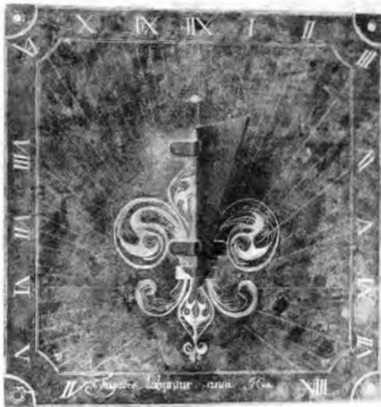
Bild 27. Horisontalur av brons med polos i form av en triangulär skiva. Förutom timlinjer och siffror har tavlan ingraverade en fransk lilja och ett Horatiuscitat: Fugaces labuntur anni . KM: 33.377.
