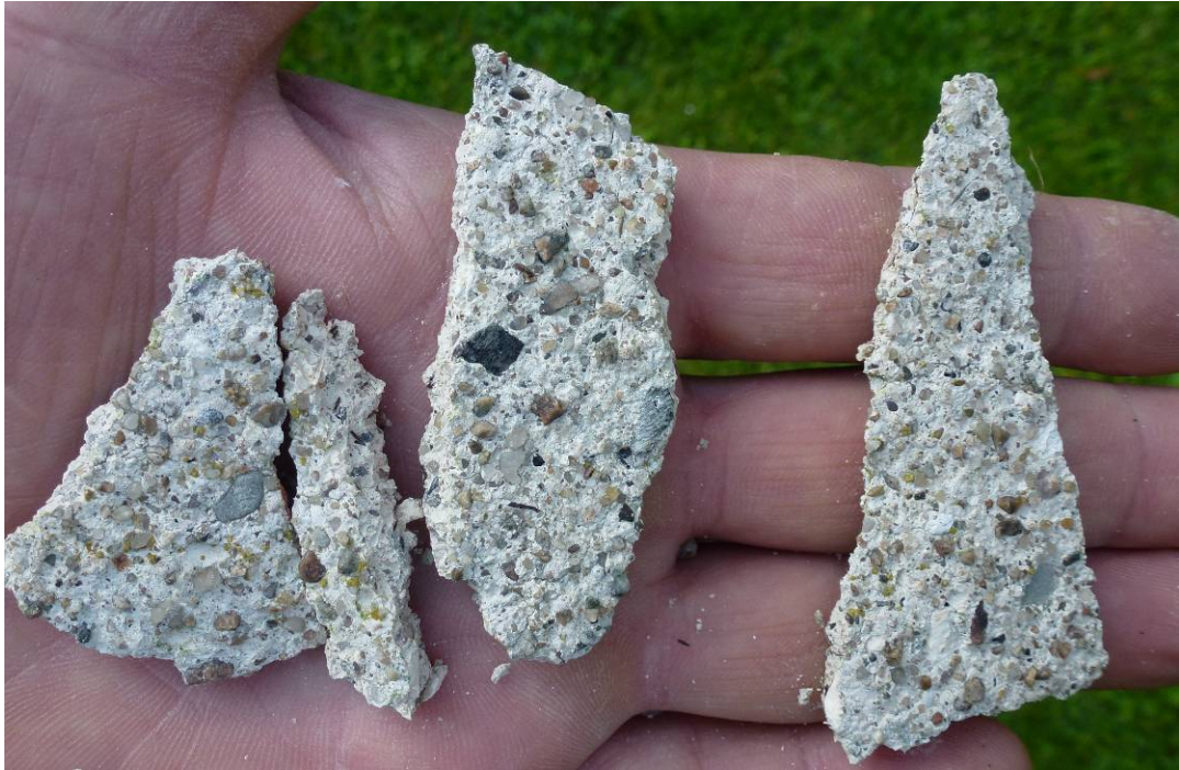
Figur 6. Den gamla befintliga putsen i anslutning till sprickorna.
