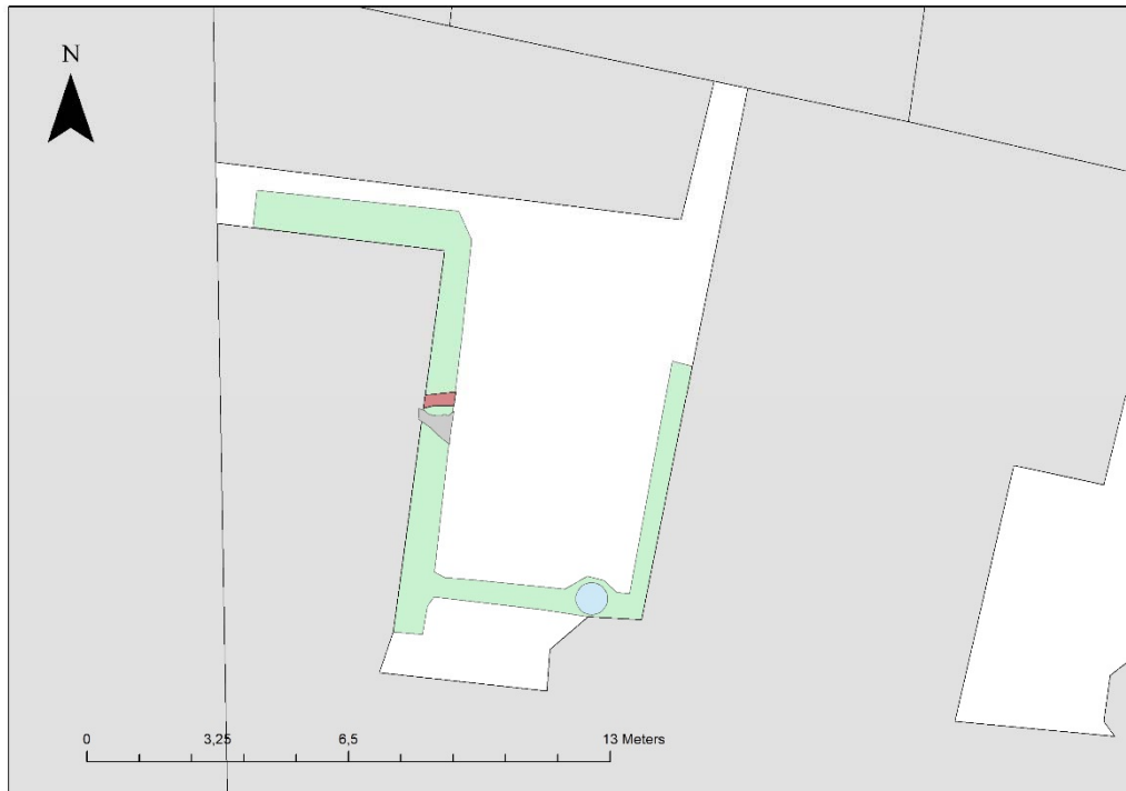
Figur 7. Planritning över schaktet på den västra innergården markerat med grönt.. Brunsgropen är markerad med blått, en tegelmur med rött och ett kalkbruklager med grått.
