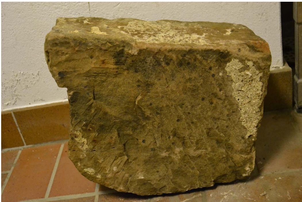
Kvadersten, huggspår av spetsmejsel, kalkbruk som tyder på återanvändning
