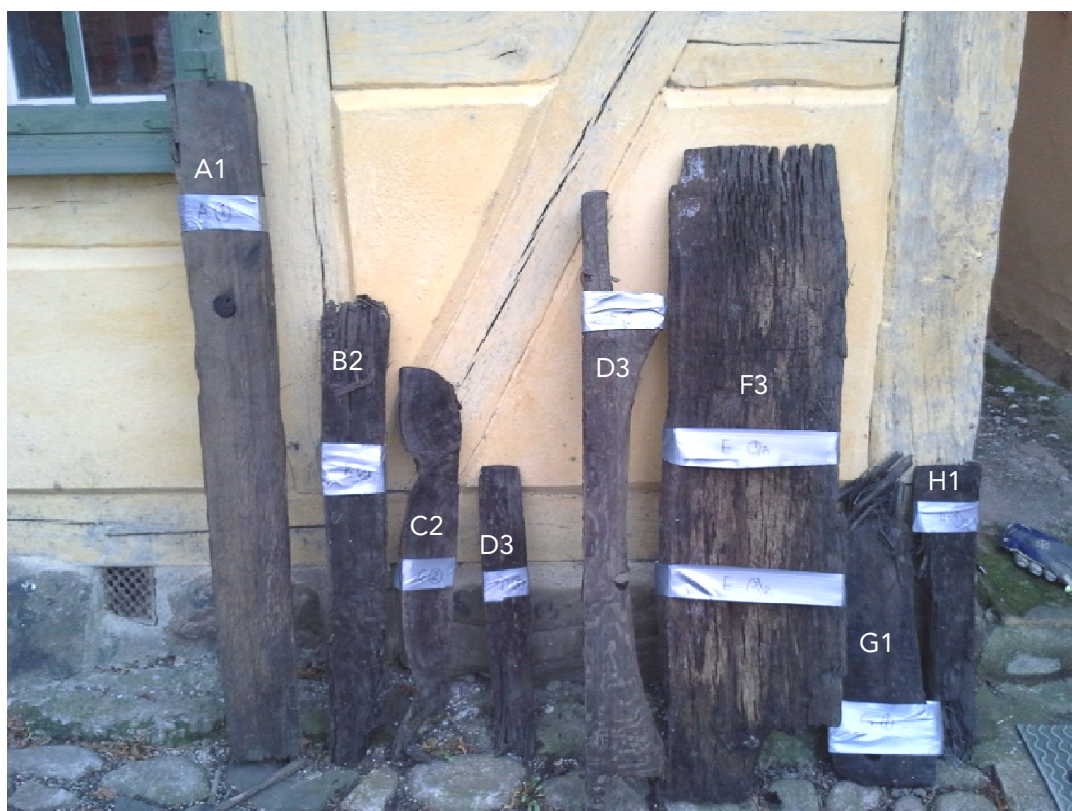
Figur 31. Brunnstimmer från Adelgatan. Silvertejpen på timret motsvarar de bitar som lämnades för analys. Samtliga provbitar var av ek. Mer information om respektive provbit återfinns i bilaga 8.
