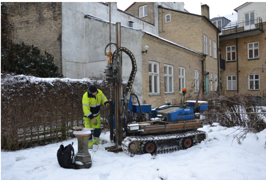
Figur 7. Kv Billegården 21, Lund. Geotekniker Rolf Svensson tar borrhprov 4 i den nordvästra delen av planerad exploateringsyta. Fotografi taget från nordväst.
