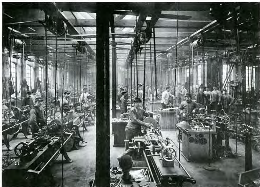
Armaturfabriken vid Gasverksgatan vid mitten av 1890-talet. Lägga märke till det komplicerade transmissionssystemet för drivningen av maskinerna. Foto Lina Jonn.
