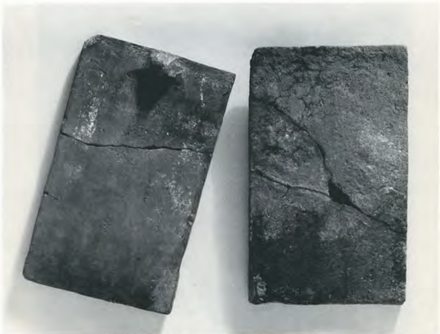
2. Plana taktegel, som en gång legat på klosterkyrkans tak. T.v. syns den släta, strukna undersidan med näsan för upphängningen, t.h. ovensidan, vars yta bär spår av sandkorn. Teglels format är 34 \times 21 \times 1,8 cm, KM 71.839:1732.
