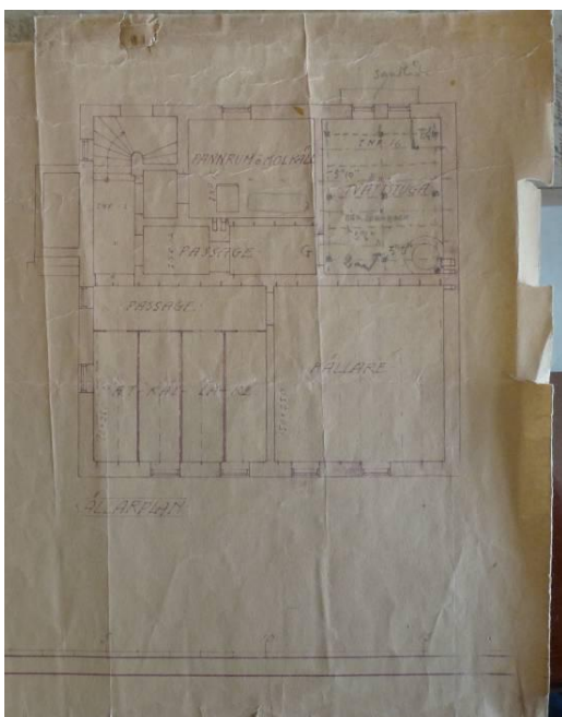
Magle Lilla Kyrkogata 17, Lund. Ritning över källarplan med förstärkt bjälklag (rummet i det övre högra hörnet). Brev undertecknat av Ingeborg Hammar skjöld-Reiz . Texten lyder: Vid besiktning 30/8 1940 av skyddsrumsanläggningen i Eder ovan angivna fastighet har densamma funnits inrättad i enlighet med föreskrifterna i lagen den 1 mars 1940. Anläggningen godkännes därför, varom detta meddelas till bevis. Lund i luftskyddschefens expedition den 30/8 1940.
