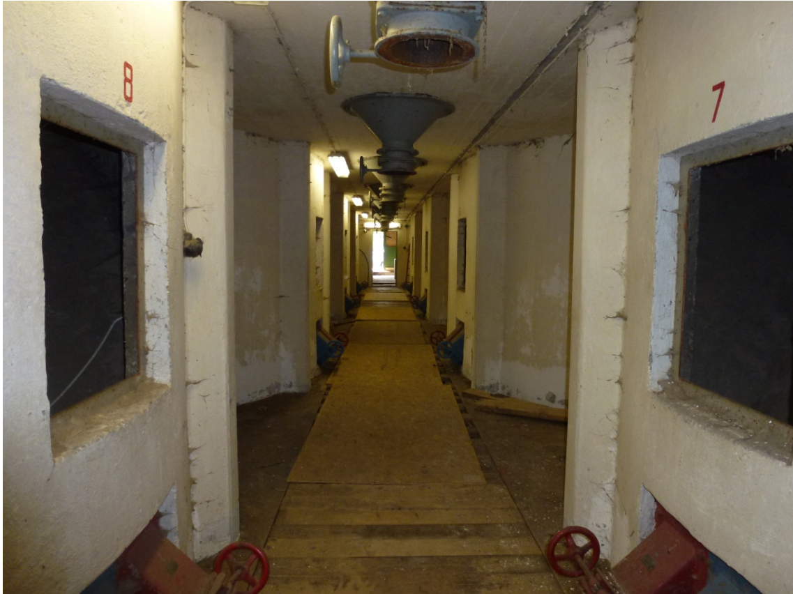
Foto Kulturen. Gången mellan silocellerna i botten. Här finns urtappning i taket och i botten av silocellerna. Maskineriet i nedre delen av silorna är från AB Kvarnmaskiner.
