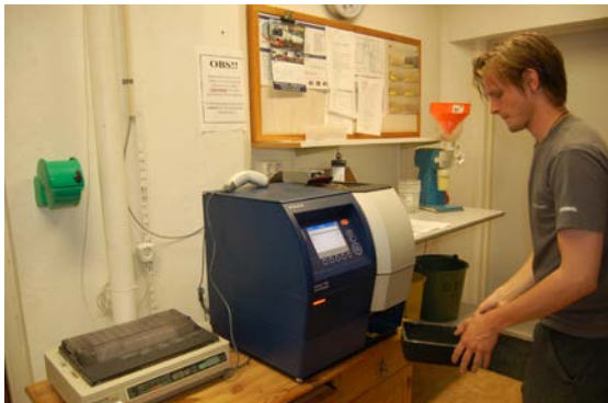
Foto Malmö Museer. En del av spannmålets väg i anläggningen. Invägning, provtagning, vattenhalten mäts samt sädhämtning från magasin.
