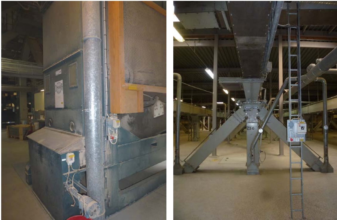
Foto Kulturen. Rens från CIMBRIA, innan torkning och lagring rensas spannmålen. I lanterninen finns transportbandet som fördelar spannmålen i silorna efter torkning.
