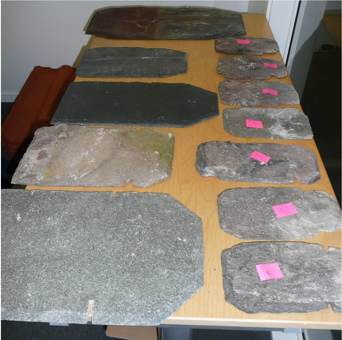
Figur 39. Skifferplattorna till höger är från Rådhuset före åtgärder. Numrerade 1-7 från ovankant i bild räknat. Jämför ritning, figur 40, för skifferplattornas placering före åtgärder.
